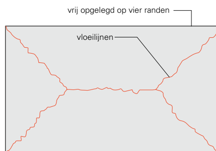
2. Vloeilijnenpatroon om weerstand van de vloer bij membraanwerking te berekenen.
