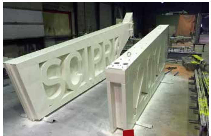
Vanwege beperking aan inspectie is extra aandacht besteed aan conservering.
