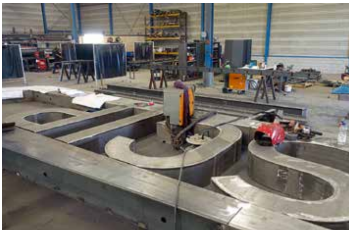
Letterproductie. 'SCIPRK' is constructief onderdeel (verstijving) van de deur.
