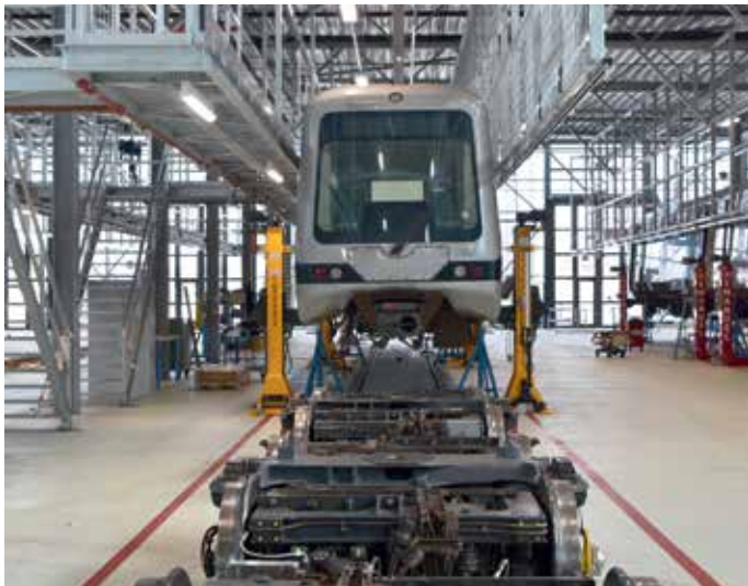
Tram wordt op hoogte gebracht.
