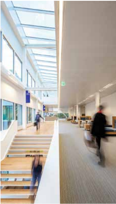
De trappartijen kunnen bij demontage ook eenvoudig worden uitgenomen.
