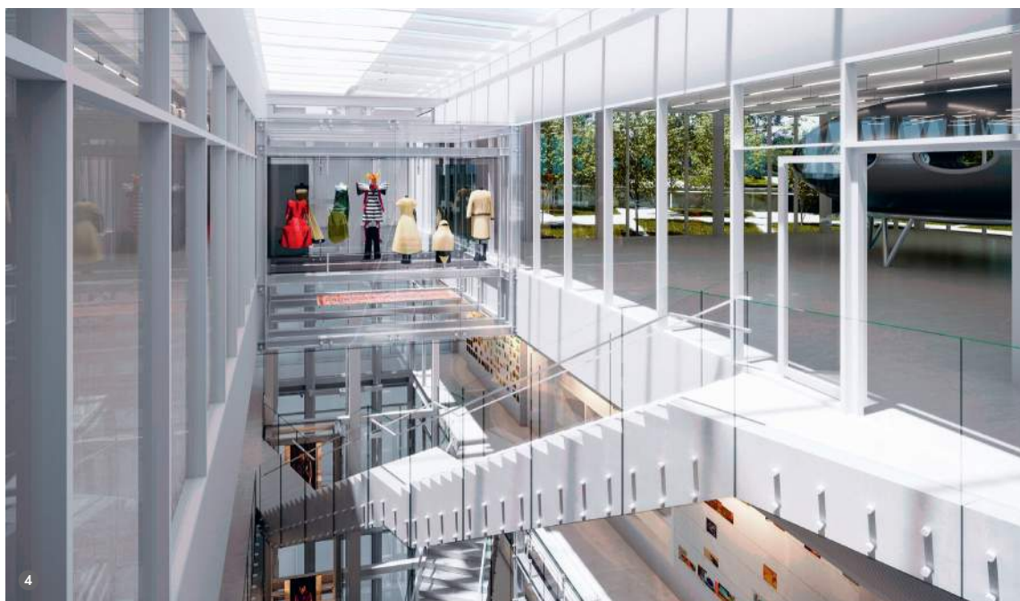
2 Het depot is een komvormig gebouw, geheel bekleed met spiegellende panelen, bron: MVRDV 3 Om zo weinig mogelijk ruimte van het Museum- CEMENT 04 2019 47 park in te nemen, is het gebouw ingesnoerd op de begane grond, bron: MVRDV 4 Centraal in het gebouw bevindt zich een atrium van 40 m hoog en 28 m lang, voorzien van een omloop op elke verdieping die wordt doorsneden door schuine, stalen zigzagtrappen, bron: MVRDV
